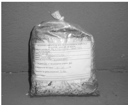
FIGURA 6 - AMOSTRA DE SOLO (DE 300 A 500 GRAMAS) COM ETIQUETA PARA SER ENVIADA PARA ANÁLISE NO LABORATÓRIO
