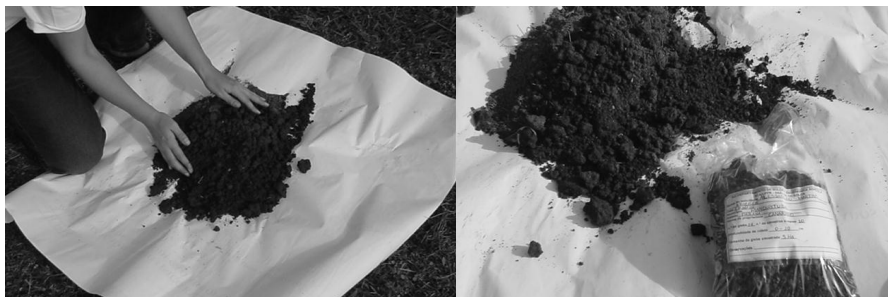
FIGURA 5 - MISTURA DAS AMOSTRAS SIMPLES PARA A RETIRADA DE UMA AMOSTRA COMPOSTA QUE REPRESENTA O TALHÃO.
